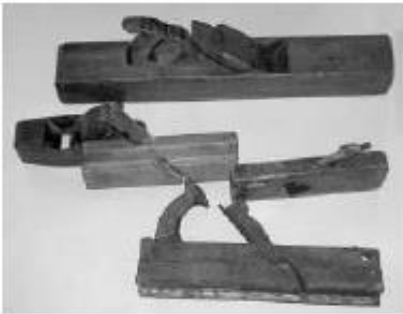
Varlope, rabot et bouvets produits à Roxton Pond (Collection Société d'histoire de la Haute-Yamaska)
